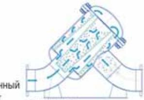
Схема работы корзинчатого фильтрующего элемента
