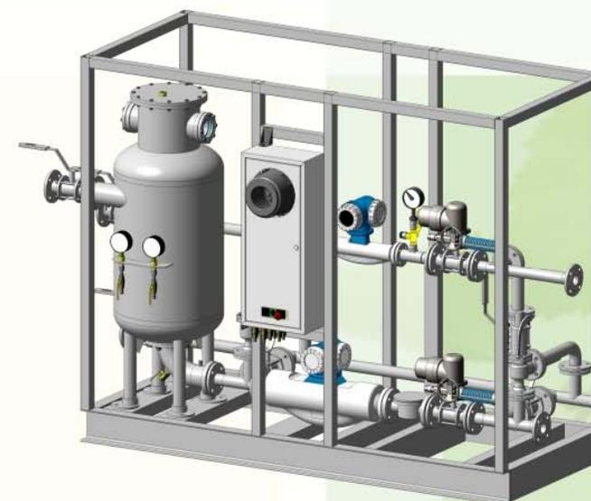
**Автоматизированная система измерения и учета СУГ при налив автоцистерн УИЖГЭ**
