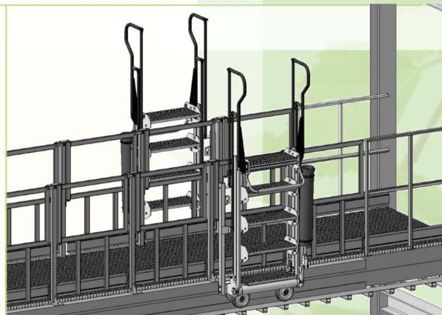
**Схема тележки передвижной для ж.д. эстакад**
