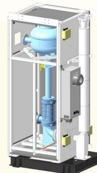
Модуль измерительный НОРД с защитным кожухом, элетрообогревом.
