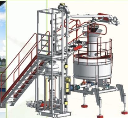
Установки поверочные массовые предназначены для поверки измерительных комплексов АСН верхнего и нижнего дозированного налива объемным и объемно-массовым методами при их выпуске из производства и в применении, на месте их эксплуатации. Установки также могут использоваться для определения плотности среды.
