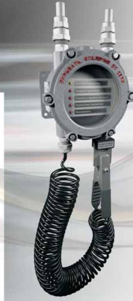
**Блок заземления автоцистерн (БЗА) предназначен для выравнивания электрического потенциала в процессе сливо-наливных операций нефтепродуктов между технологическим оборудованием и загружаемой емкостью. Прибор обеспечивает снятие заряда статического электричества с проводящей поверхности оборудования и отвод его на заземляющий контур.**
